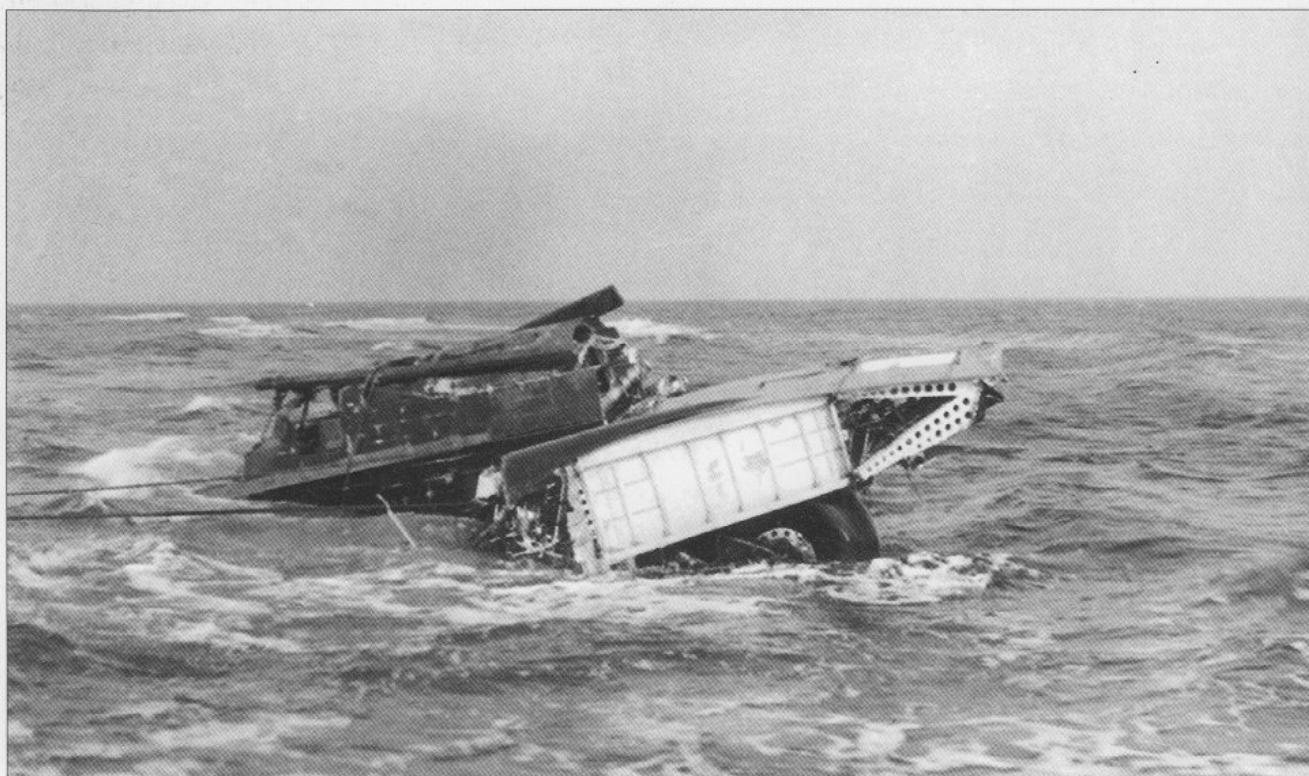
Bärgningsarbetet blev drygt och de sista delarna bärgades inte förrän 1976. Här pågår vinschning av vingsegment med vidhängande motor och landställ.
