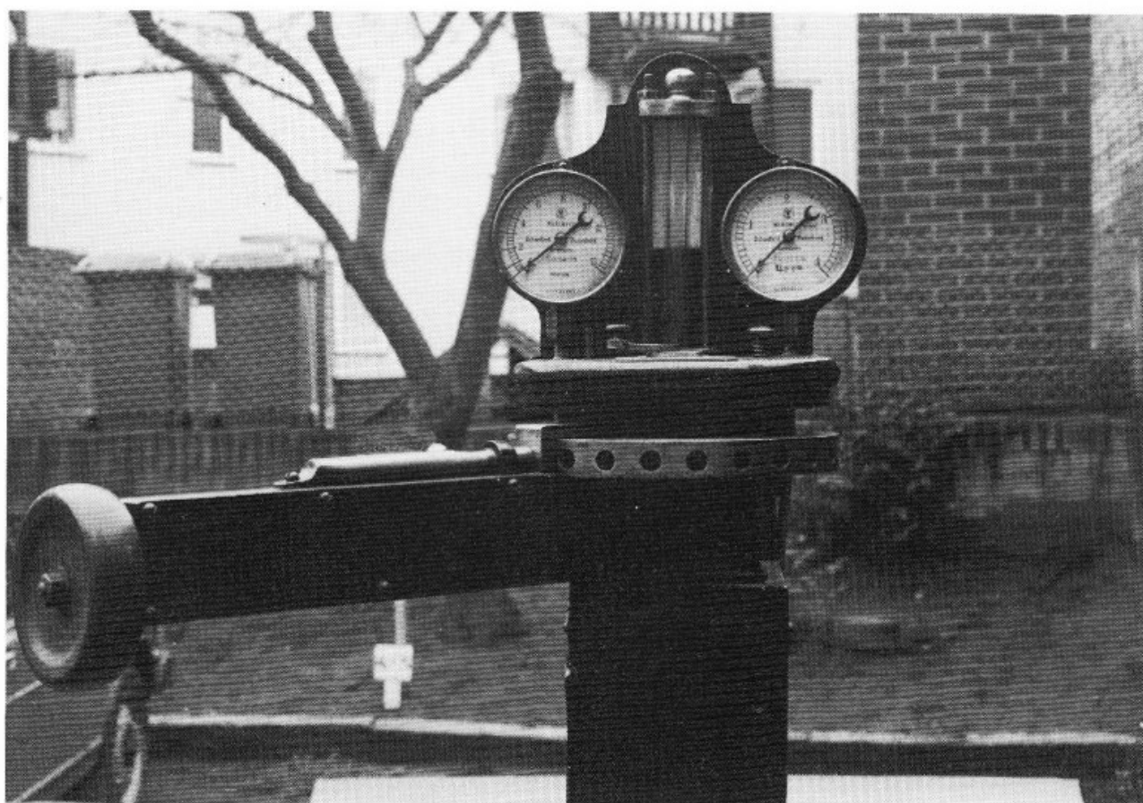
På styrstativet finns två manometrar, den vänstra för ångtrycket, den högra för bränsletrycket i fotogentanken. I mitten pannans nivåvisare.
